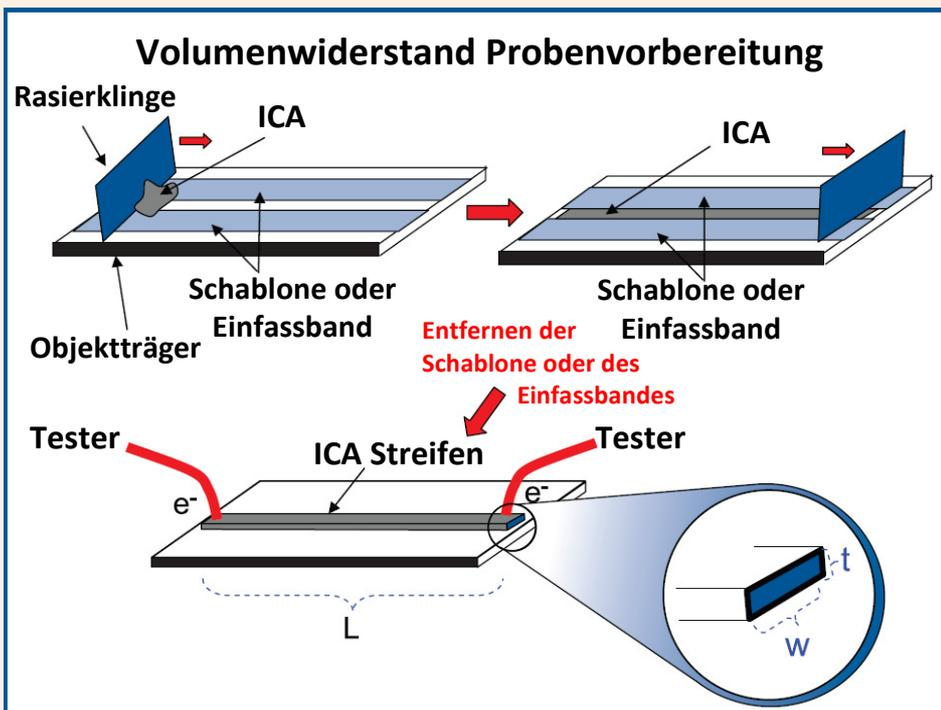
Sobald die Probe vorbereitet worden und ausgehärtet ist, werden die zwei Pole eines Voltmeters an die Enden des Streifens aufgebracht, um den Widerstand über die Probe zu messen. Der Volumenwiderstand wird nach der folgenden Gleichung berechnet:
